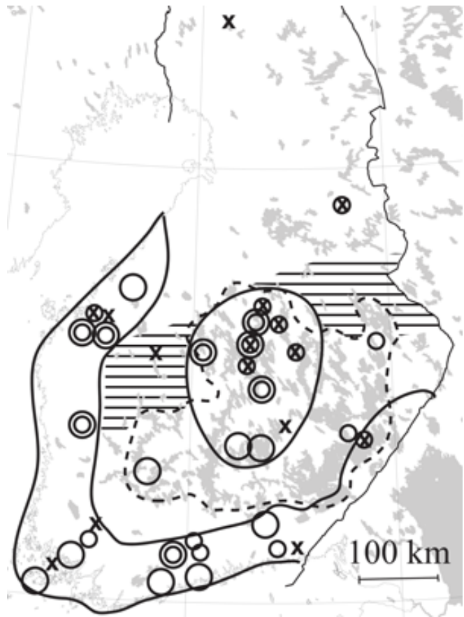
Kuva 1. Yhden, viiden ja neljäntoista vuorokauden suurimmat sademäärät Suomessa 1959 – 2004. Alarajat ja symbolit: 1 vrk 93 mm (ristein), 5 vrk 140 mm (pienin ympyröin) ja 14 vrk 175 mm (suurin ympyröin). Rannikko ja Sisä-Suomi, joissa on 88 % tapauksista, on rajattu yhtenäisin viivoin. Suurimpien valuma-aluekohtaisten kuukausisademäärien alue käsittää näiden lisäksi varjostetut alueet. Järvi-Suomi on rajattu katkoviivoin.
